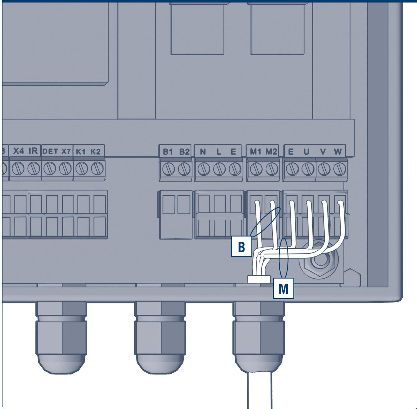
В — электромагнитный тормоз двигателя
