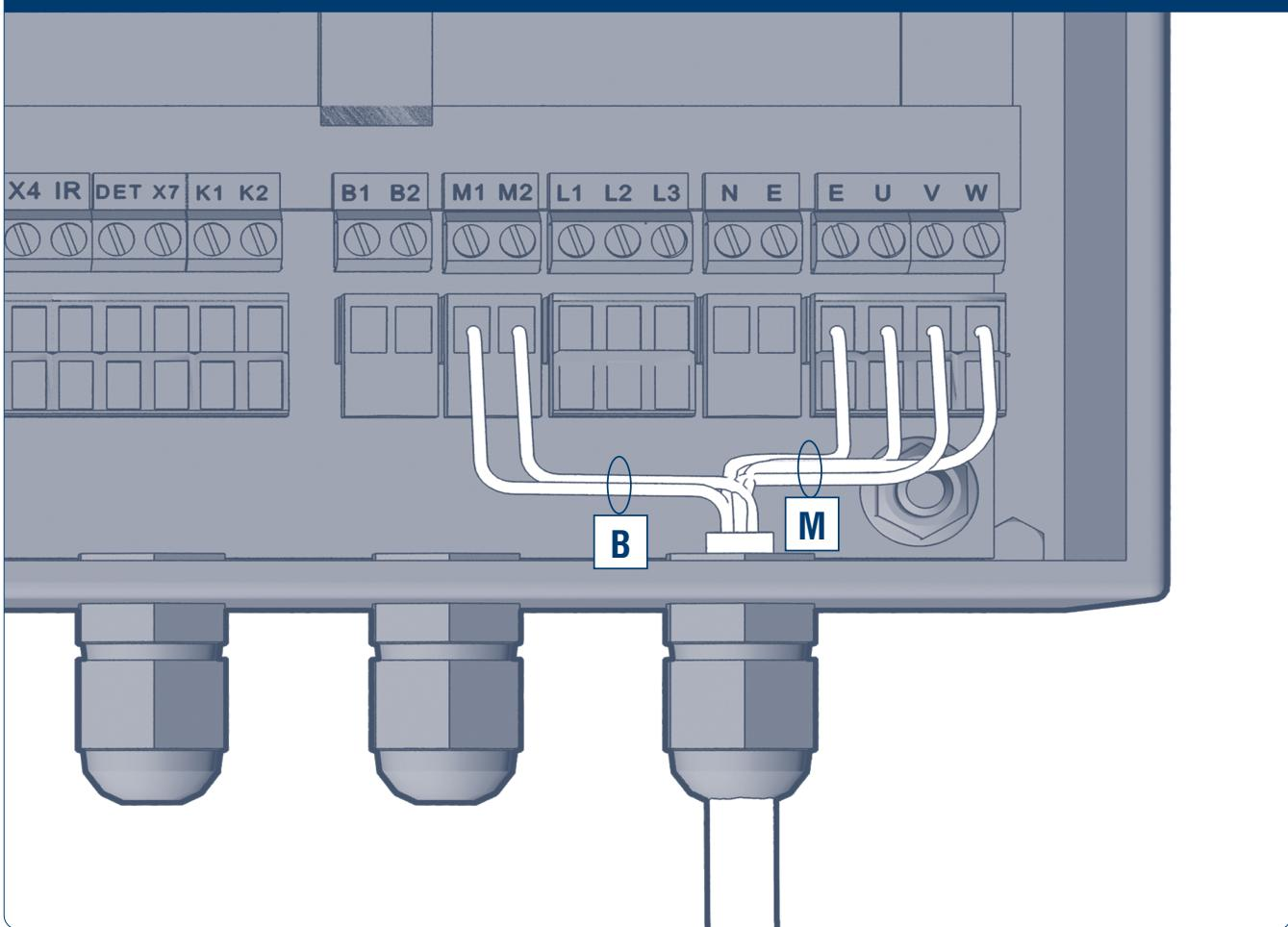
B — электромагнитный тормоз двигателя
