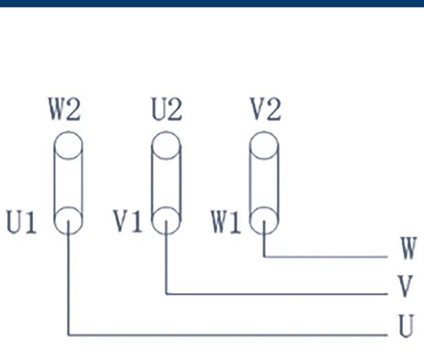
Рис. 5. Схема «звезда»
