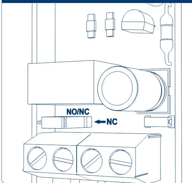
Рис. 43.2. Фотоэлемент. Положение перемычки – NO
